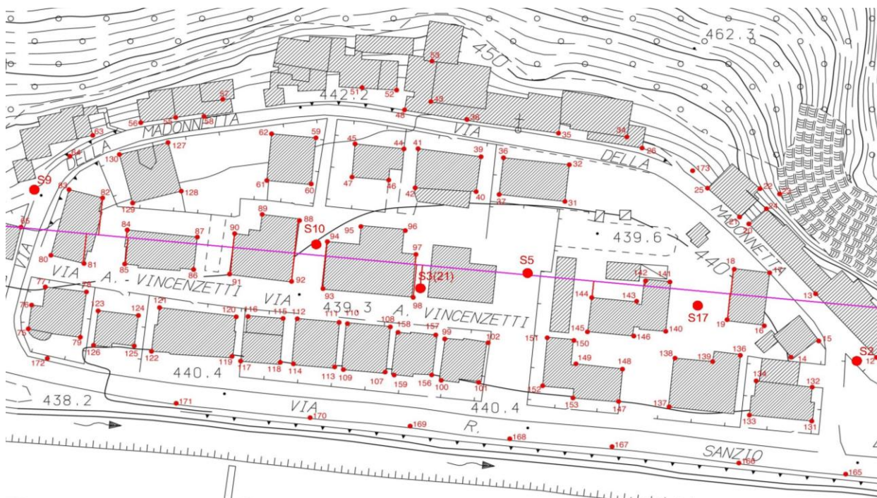
Figura 5.69: Indicazione dei capisaldi di riferimento per il confronto fra cedimenti misurati dal 1998 al 2021 e i cedimenti ottenuti dalla modellazione per la sezione D-D'.
