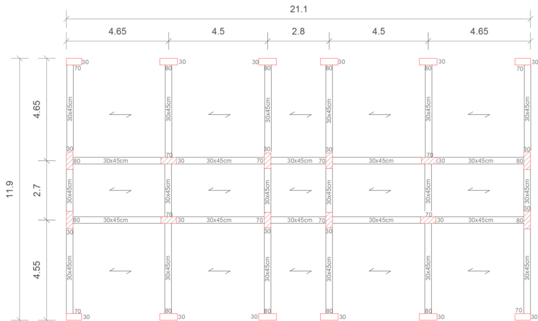
Figura 7.24: Carpenteria solaio di copertura struttura in c.a. a tre piani.
