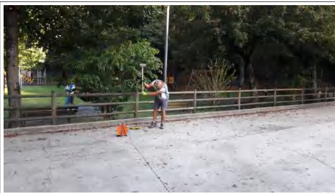
Fig. 5: Energizzazione Onde di Rayleigh.
