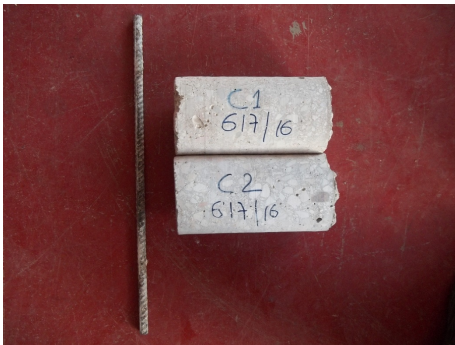
FOTO 2 – Campioni di calcestruzzo e barra prelevati
